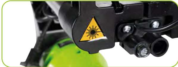
Laser do precyzyjnych cięć lézer a precíz vágáshoz
