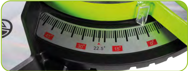
Skala kątowa do cięć ukośnych szögskála a ferde vágásokhoz
