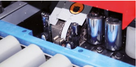
integrierte Doppelsägeblatt-Kantenendabschnittseinheit internal double blade end cutting unit
