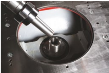
Wechselspindel mit MK4 Aufnahme exchangeable spindle arbor MT4
