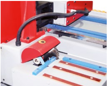
Kantenendanschnitt als externe Einheit ausgeführt external end cutting unit
