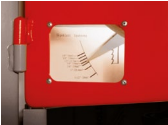
Bandspannungsanzeige band tension indicator
