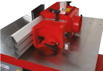
präzise einstellbare Fräshaube , Querführung und Feineinstellung precisely adjustable hood with crossway guide
