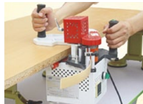
Anleimung an gerade Kanten straight edge bending
