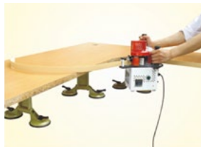
Anleimungen an Schweifungen / Radien curve edge bending
