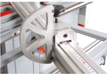
Teleskopanschlag, 2 Anschlagklappen für Direktablesung stable fence with work piece end stop
