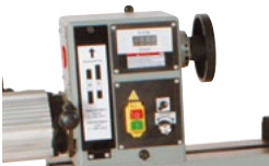
LCD Geschwindigkeitsanzeige serienmäßig LCD speed indication included in delivery
