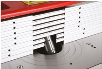
Integral-Sicherheitsschienen integrated fence
